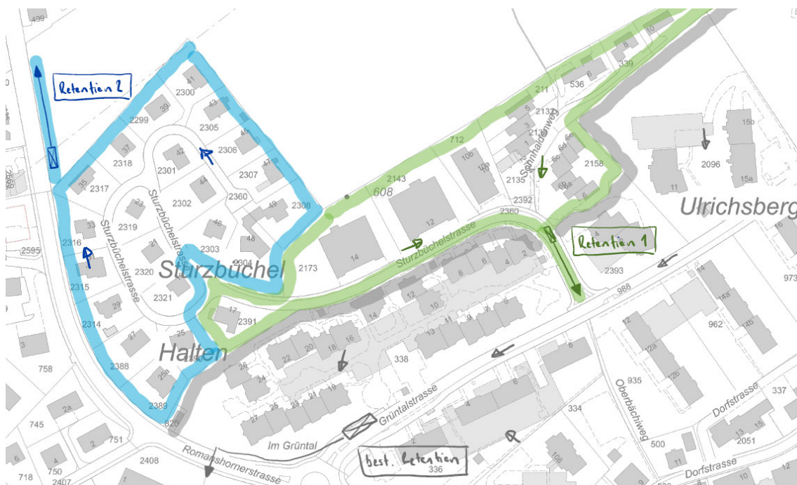
Abbildung 2: Skizze Auftrennung Kanalisation, Wälli AG Ingenieure, 04.08.2022
